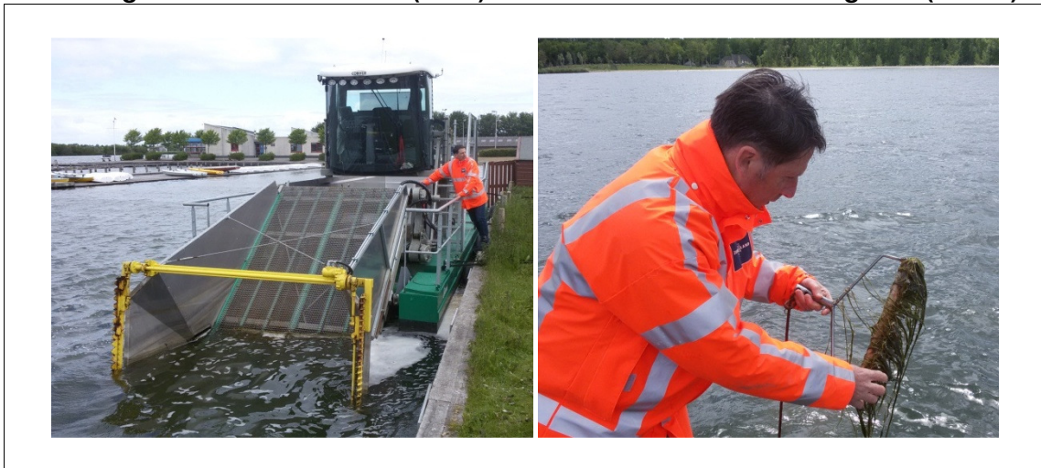
Afbeelding 4.1. Maaiboot Sirenia (links) en fonteinkruidenten aan de dreghaak (rechts)
